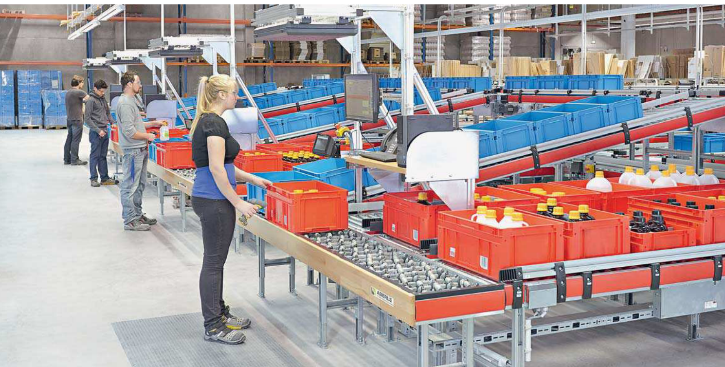
⑦ Nach dem Put-to-Light-Verfahren werden im Wareneingang die zur Einlagerung ins AKL bestimmten Artikel aus den blauen in die roten Behälter umgesetzt
