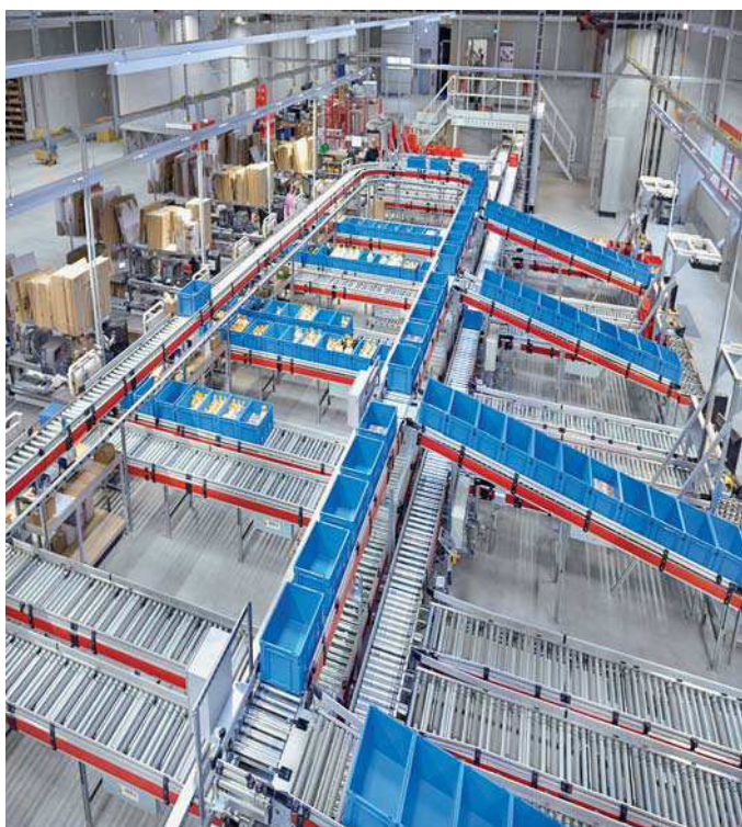
⑧ Über einen zentralen Loop gelangen die kommissionierten Auftragsbehälter zu den sechzehn Arbeitsplätzen
