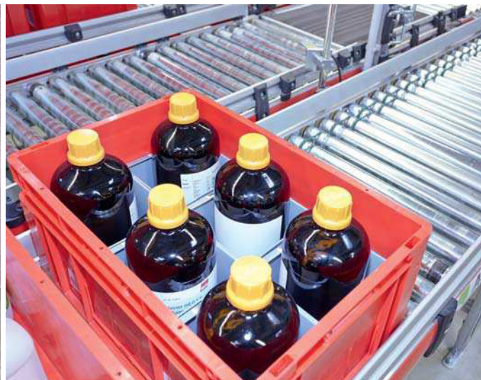
④ Die bei Carl Roth eingesetzten Behälter können in bis zu 24 Fächer unterteilt werden. Das Bild zeigt einen Behälter mit 6-facher Unterteilung auf dem Weg ins AKL
