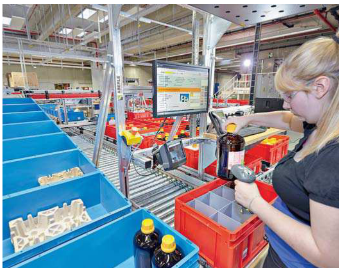
⑤ Farbenspiel: Bei Carl Roth werden für das AKL rote und für den Rundlauf zwischen Kommissionierung und Verpackung blaue Behälter eingesetzt
