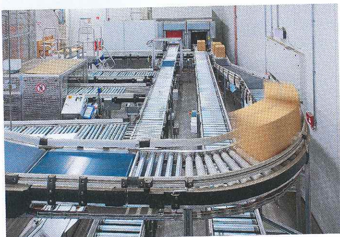
3 Das automatische Kleinteilelager und die förder-technische Verbindung zur Kommissionierzone sind für eine Vielfalt unterschiedlicher Behältergrößen und -qualitäten ausgelegt
